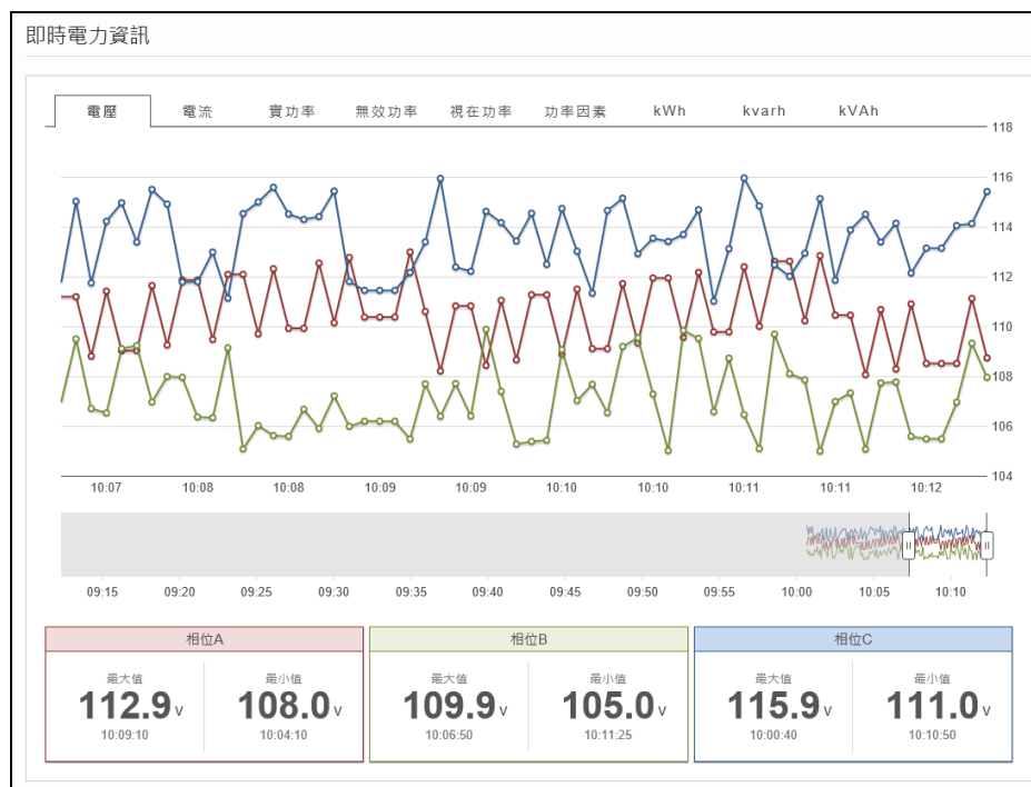
圖 7-6 即時電力資訊－電錶迴路即時資料趨勢圖顯示
